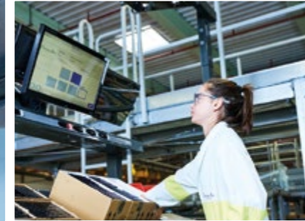
Das Ware-zur-Person-Prinzip optimiert die manuelle Kommissionierung: Die Waren stehen in ergonomischer Höhe zur Verfügung. Übersichtliche Bedienoberflächen optimieren die Qualität.
