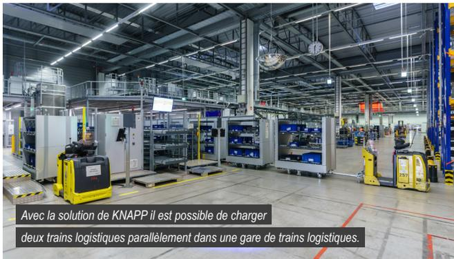
Avec la solution de KNAPP il est possible de charger deux trains logistiques parallèlement dans une gare de trains logistiques.
