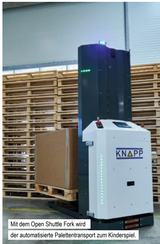
Bei Würth werden Kleinladungsträger von 2 Robotern vollautomatisch in der richtigen Reihenfolge auf die Versandpaletten gestellt. Das Open Shuttle Fork übernimmt dann den Transport der Palette
