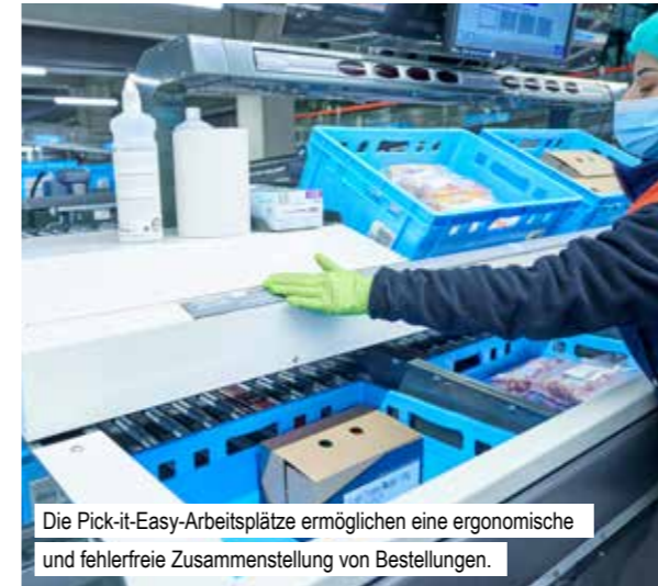
KiSoft Pick-to-Light führt den Mitarbeiter durch den Kommissionierprozess.
