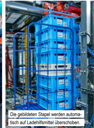
Sechs Stapelmaschinen stellen stabile und shopspezifische Stapel zusammen.
