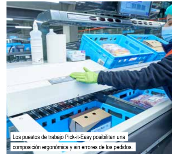
KiSoft Pick-to-Light guía al operario por el proceso de preparación.
