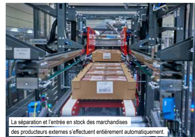
Le centre de distribution est relié au site de production adjacent via un convoyeur.
