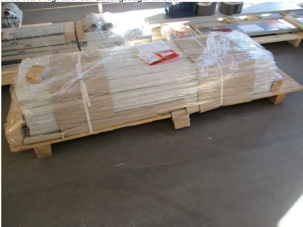
Unzureichende Verpackung. Transport ohne Schutz vor seitlicher Einwirkung
