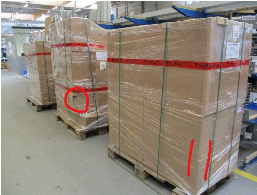
Unzureichend verpackt und gekennzeichnet. Ware steht über die Paletten hinaus. Fehlender Kantenschutz. Fehlender Lieferschein. Fehlende Artikelbezeichnung.
