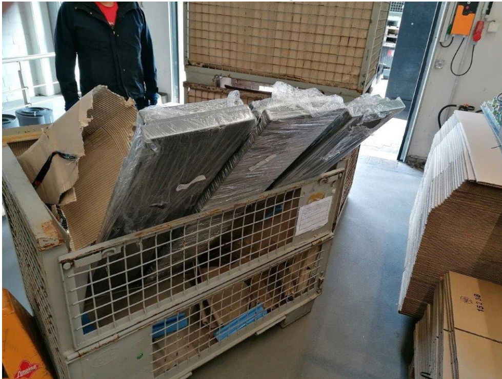
Gitterbox als unzulässiger Ladungsträger verwendet. Ware gelehnt und unbereift, so dass Metall an Metall reibt. Ware ragt über den Ladungsträger hinaus.
